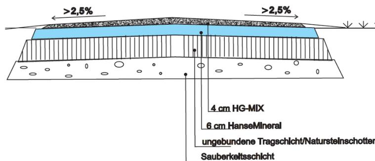
**HanseMineral®** verbessert den Wasserhaushalt und erhöht die langfristige Belastbarkeit der halbgebundenen Wegedecke. Durch die wasserregulierende Funktion vermeiden wir Staub- und „Schmierfilmbildung“. Außerdem schließt es die Lücke in der Kornabstufung von der Tragschicht zur Deckschicht. HanseMineral® eignet sich auch gut zum Nachprofilieren ausgefahrener Wege.
