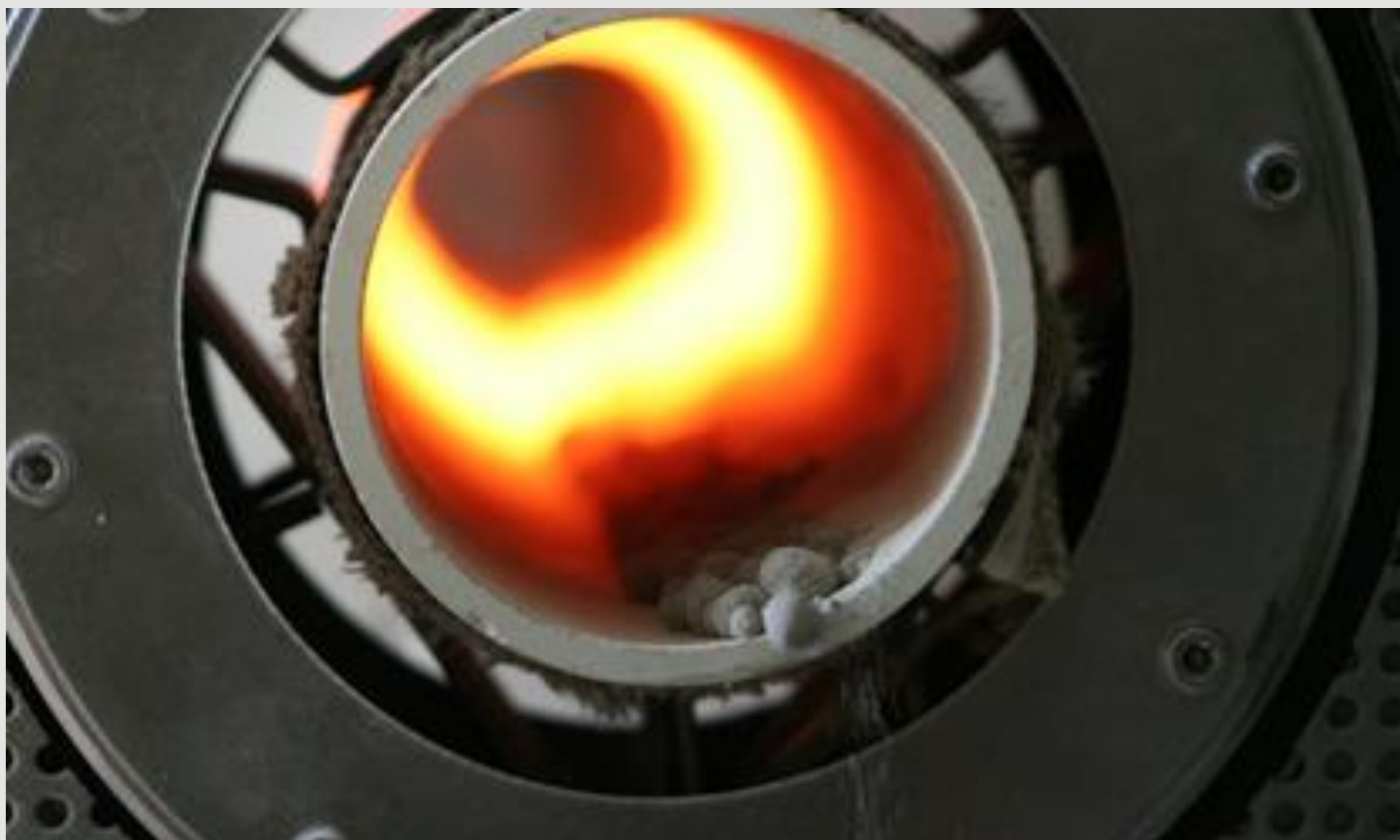
Brennversuche zur Herstellung von LWA aus Bauschutt im Labor der Bauhaus-Universität Weimar (Foto: BUW)
