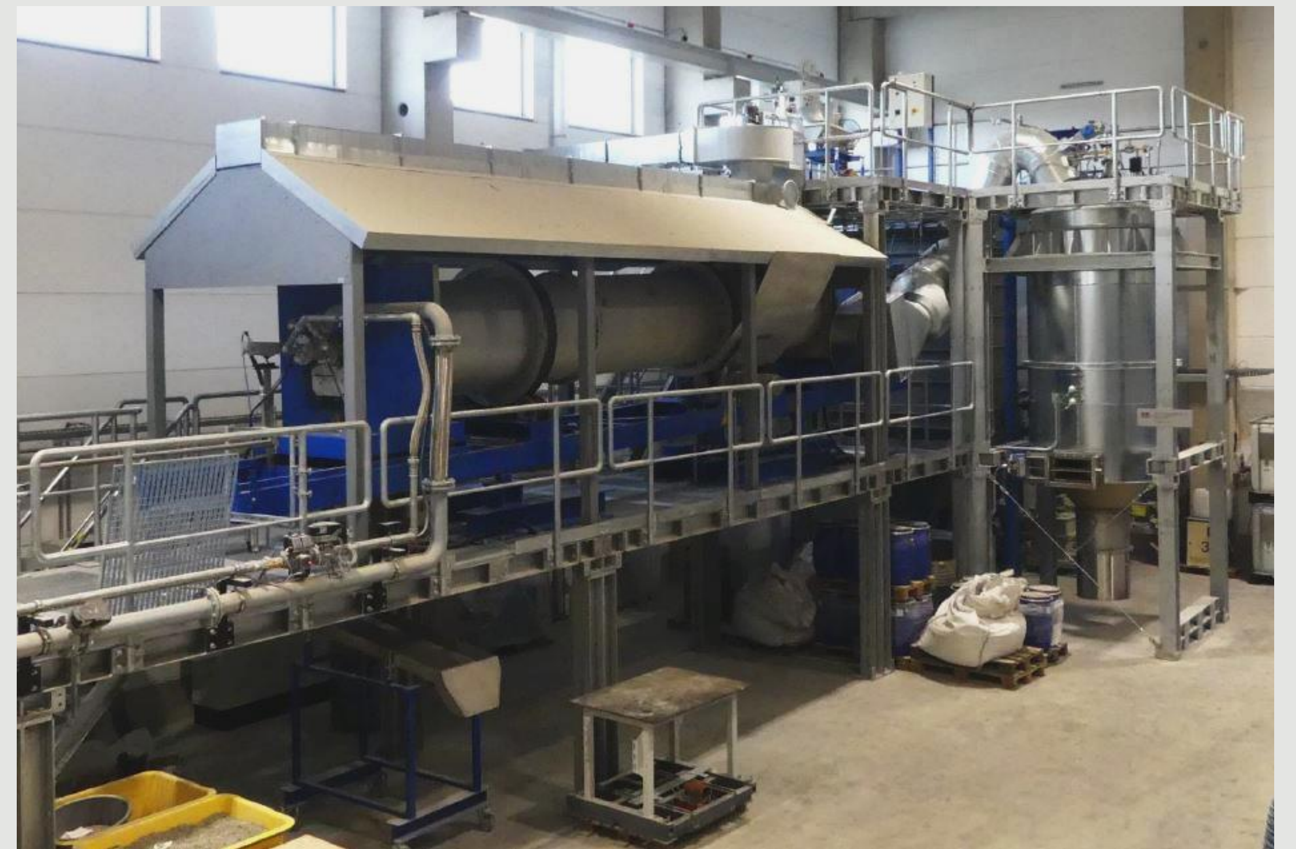
Scale-up der Blähgranulatherstellung im Drehrohrföfen der IAB Weimar gGmbH (Foto: IAB)
